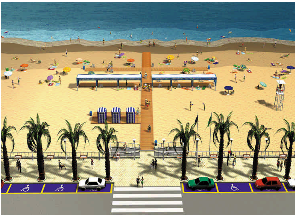
Figura 1.- Diseño de punto accesible en playas para personas con movilidad reducida
