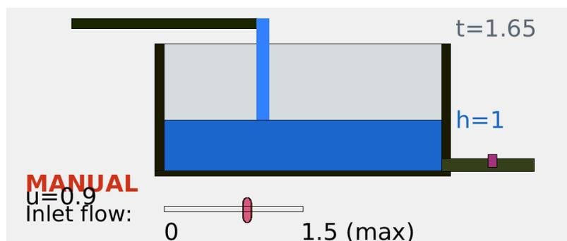
Dos entradas: caudal  $u$  y grado de apertura de válvula de salida  $\kappa$ .
