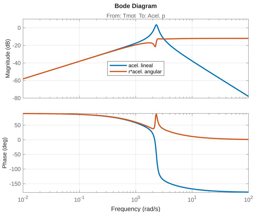
Las amplitudes de "posiciones" en resonancia servirían, por ejemplo, para comprobar si no habrá colisiones al ser excitado a determinada frecuencia, las aceleraciones (o sea, fuerzas) están relacionadas con el confort de ocupantes de un ascensor, por ejemplo... Cada aplicación tecnológica tiene unas "salidas de interés" diferentes.
