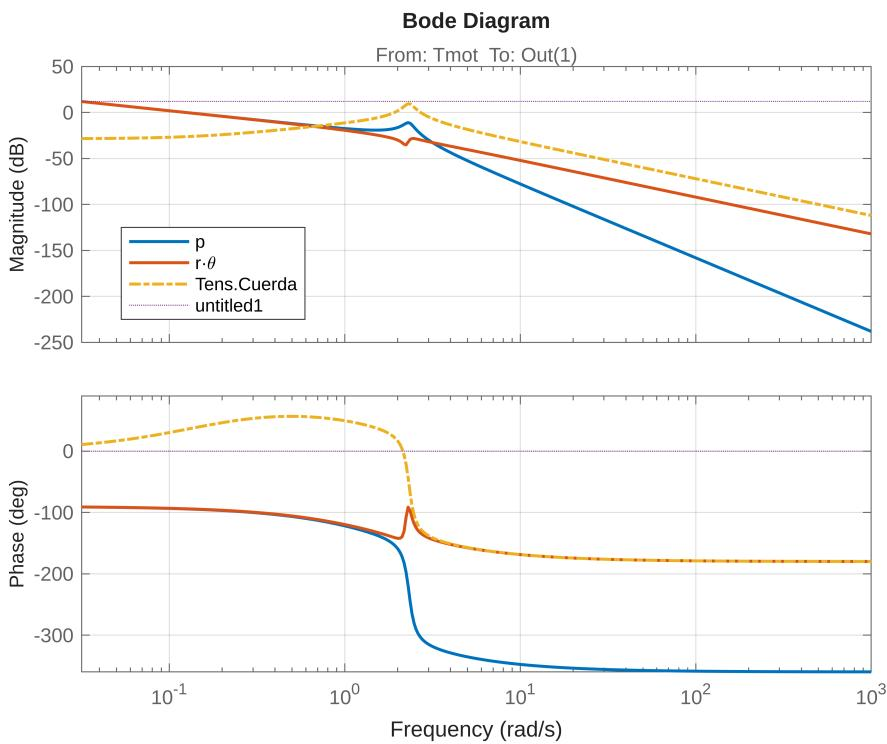
\*La inestabilidad marginal se nota como que la amplitud de la respuesta en frecuencia **tiende a infinito** a baja frecuencia... Pero, en un caso general, **podría ser que la inestabilidad "exponencial" no se viera en la respuesta en frecuencia  $G(j\omega)$** : el sistema  $G(s) = 1/(s - 2)$  tiene una respuesta en frecuencia acotada a todas las frecuencias  $1/(j\omega - 1)$ , pero el transitorio exponencial es inestable.
