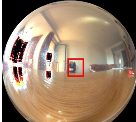
Figura 3.10: Errores en la generación de la imagen de alto rango dinámico
