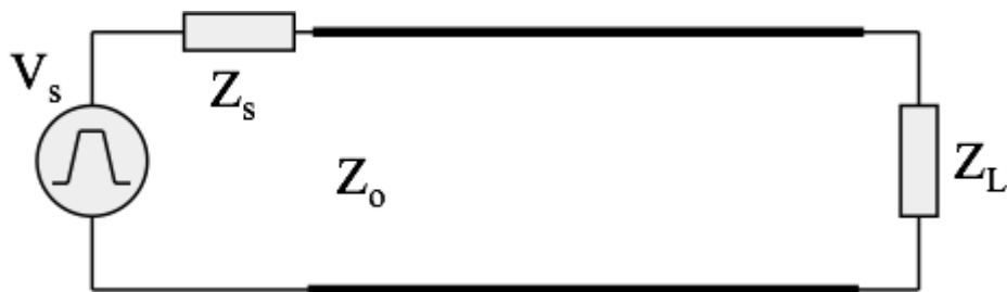
Figura 2.12. Representación esquemática de una línea transmisión (tramo grueso) con una impedancia de carga Z_L y un driver con impedancia de fuente Z_S . Fuente propia
