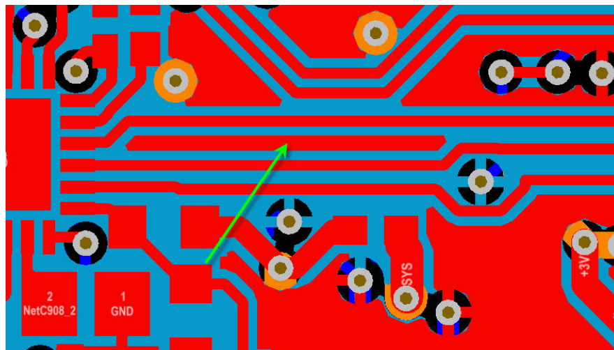
Figura 5.13. Ejemplo de potencial antena parásita, indicada por la flecha verde. Fuente:
