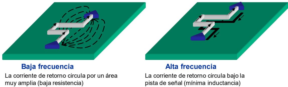
Figura 2.6. Camino de la corriente de retorno en alta y baja frecuencia. Fuente propia.
