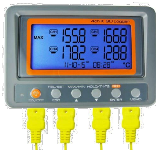
Figura 14.15. Registrador de temperatura de 4 canales de bajo coste
