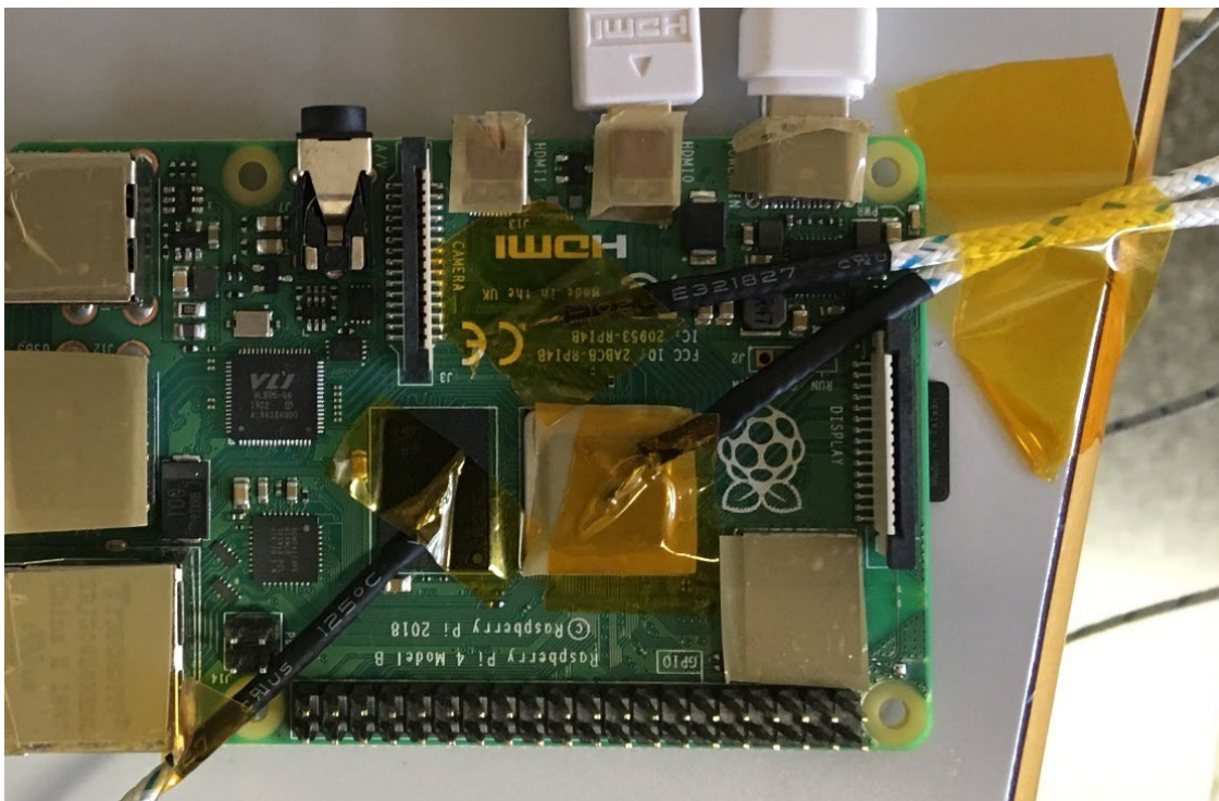
Figura 14.17. Termopares fijados al SoC, memoria DDR3 y a un punto del PCB. La cinta adhesiva de kapton permite una fijación rápida y fácil
