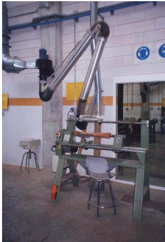
Figura 3. Torno para piezas de madera, provisto de extracción.
