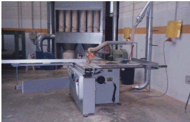
Figura 2. Sierra circular provista de extracción localizada y empujador de piezas
