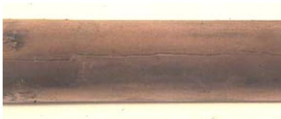
Corrosión por stress en tubo de cobre del absorbedor.
