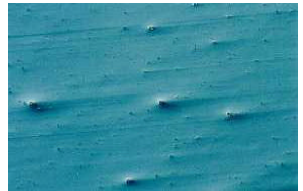
Figura 3.9. Defectos de colas de cometa, típicos del pulido.
